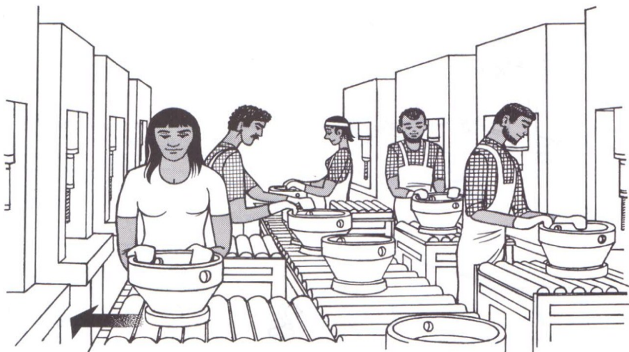
Hình 43. Một dây chuyền thụ động giúp di chuyển các động cơ đúc nặng ở độ cao làm việc.
